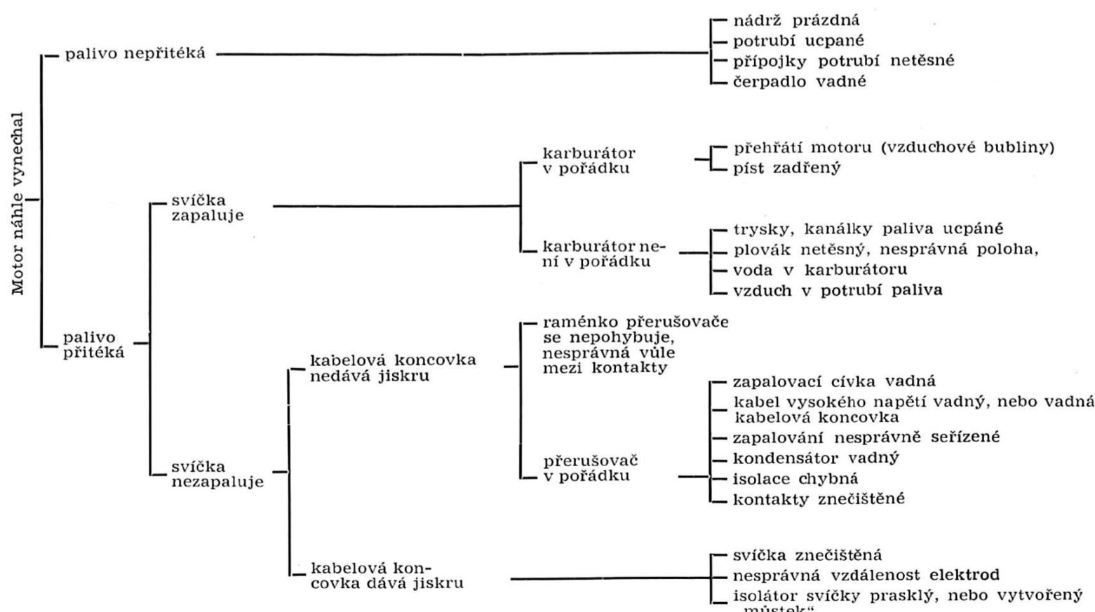
**Poznámka:** Chceme-li zjistit, je-li palivová soustava ucpána, začneme hledat u trysky a postupně pokračujeme až k nádrži. Při předpokládané poruše v elektrickém zařízení, nejdříve zkoušíme sekundární obvod; postupujeme od svíčky zpět k cívce; nejzjistíme-li závadu, kontrolujeme primární obvod od cívky k akumulátoru.
